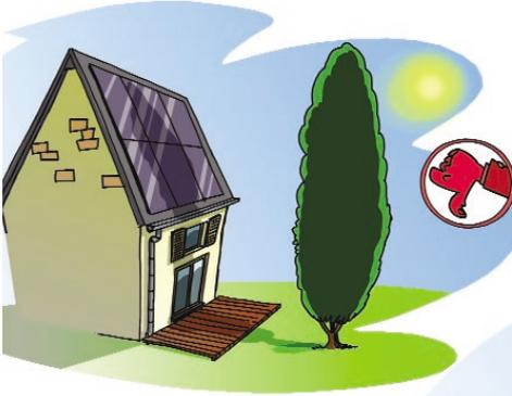
La production est maximale lorsque les panneaux sont propres et sans ombrage.
