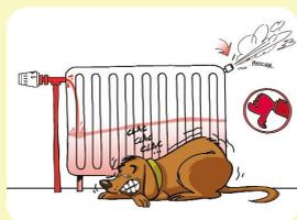
Si le haut du radiateur est froid, c'est qu'il est rempli d'air. Il faut purger le radiateur.
